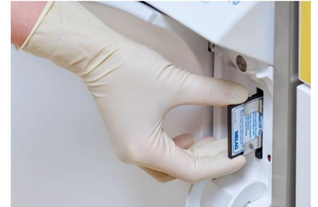
Für höchste Sicherheit überwachen die MELAG Thermodesinfektoren alle relevanten Prozessparameter. Die erstellten **Protokolle sind rechtssicher und können per CF-Card oder den beiden Netzwerkschnittstellen ausgelesen werden.**
