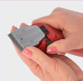
Scherköpfe wechselt man bei laufender Maschine. Dazu ist der seitliche Hebel an die Maschine zu drücken. Stellen Sie sicher, dass der Scherkopf ganz auf den Schwalbenschwanz aufgeschoben wurde.
